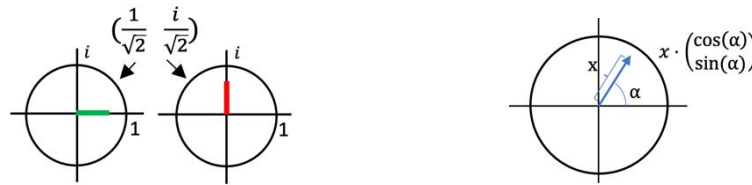
Abbildung 34: Darstellung von komplexen Zahlen in Zeilenvektoren und als Zeigerdiagramm und Darstellung der Polarisation als Spaltenvektor und Pfeil
